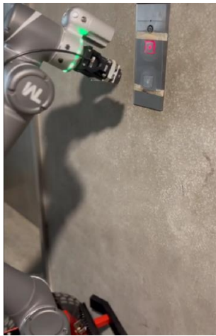
Fig.10 機械手臂按壓電梯按鈕
